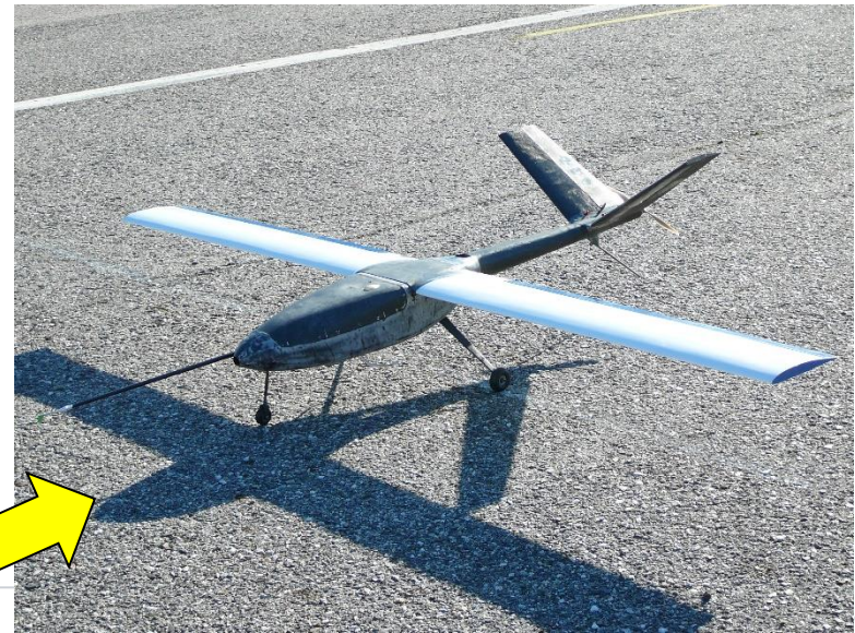
Olharapo 2 com fuselagem maior e hélice na traseira do cone de cauda
