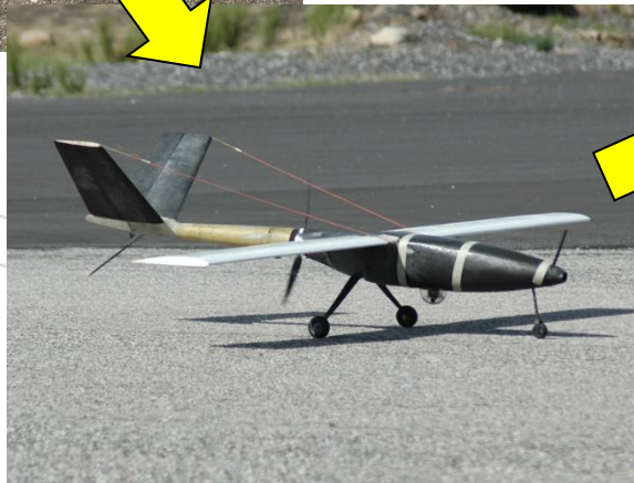
Olharapo 1 com fuselagem longa e hélice no meio do cone de cauda
