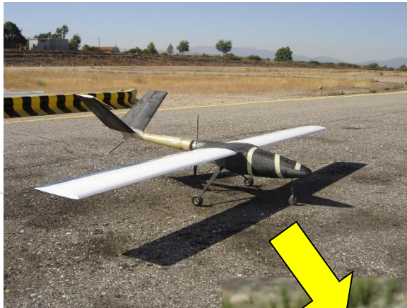
Olharapo 1 com fuselagem curta e hélice no meio do cone de cauda
