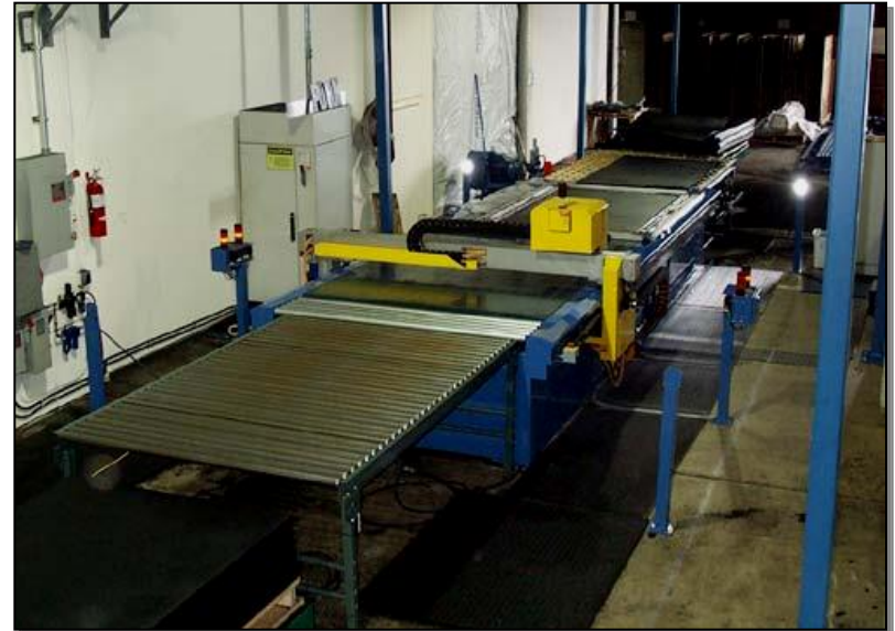
Aspecto geral da faca de corte (actuando sobre “ninho de abelha”) e equipamento típico Kniff cutter aspect (cutting honeycomb) and typical equipment
