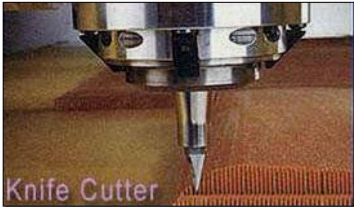
Aspecto geral da faca de corte (actuando sobre “ninho de abelha”) e equipamento típico Kniff cutter aspect (cutting honeycomb) and typical equipment
