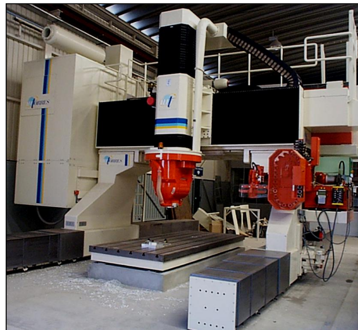
Fresadora CNC de 5 eixos de pórtico CNC 5 axes milling machine gantry type
